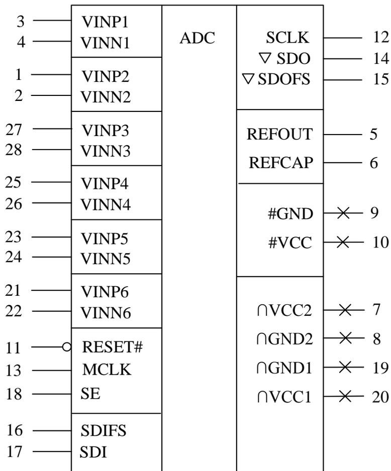
Рисунок 1 – Условное графическое обозначение ИС 1273ПВ19Т
