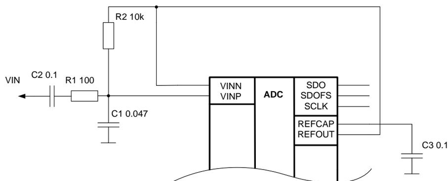
Рисунок 16 – Однопроводной входной сигнал (подключение по переменному току)
