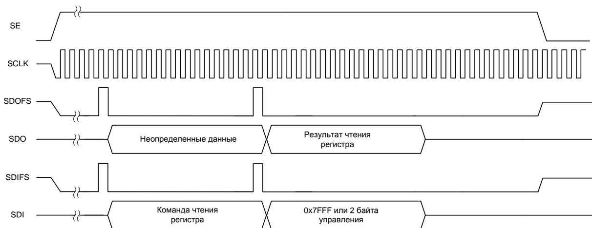
Рисунок 10 – Диаграмма данных в режиме программирования (чтение)
