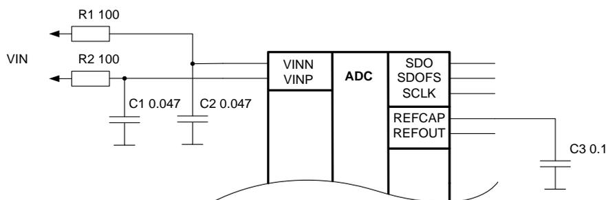
Рисунок 14 – Дифференциальный вход (подключение по постоянному току)
