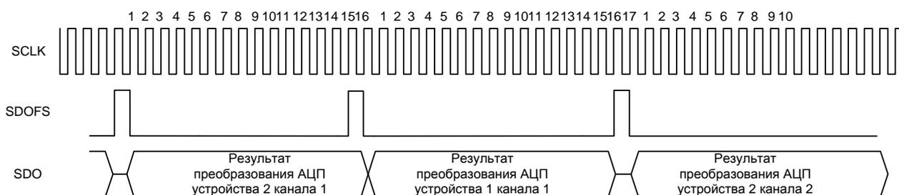
Рисунок 13 – Временные диаграммы двух устройств в режиме каскадирования
