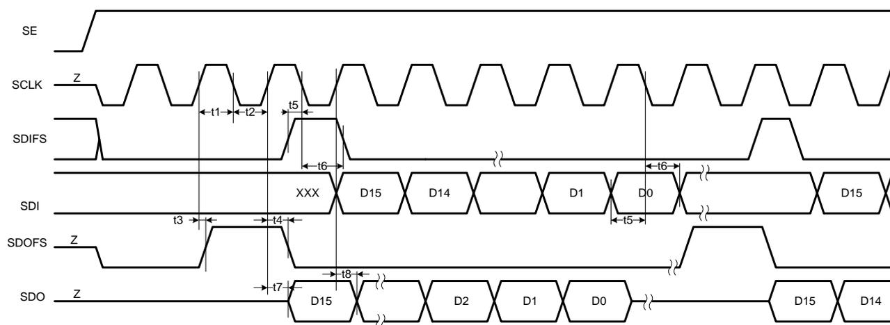
Рисунок 3 – Временные диаграммы работы последовательного порта
