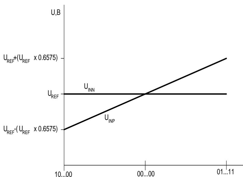
Рисунок 5 – Передаточная функция АЦП в режиме однопроводного входа
