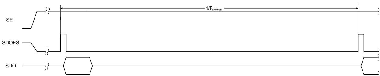
Рисунок 6 – Диаграмма выходных данных в режиме программирования
