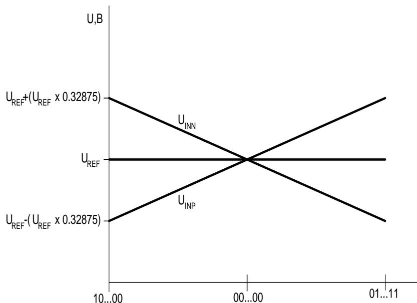
Рисунок 4 – Передаточная функция АЦП в режиме дифференциального входа
