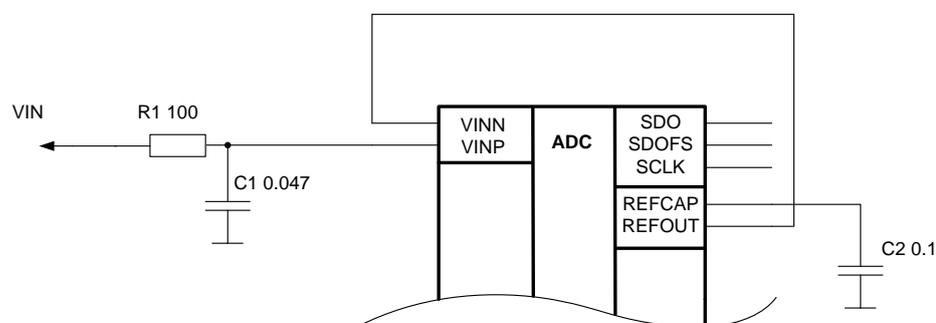
Рисунок 17 – Однопроводной входной сигнал (подключение по постоянному току)
