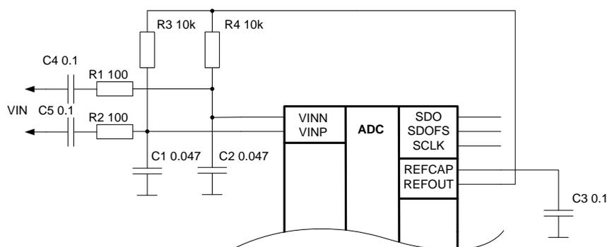
Рисунок 15 – Дифференциальный вход (подключение по переменному току)
