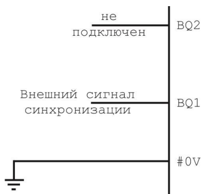
Рисунок 3.12 – Конфигурация при тактировании от внешнего генератора
