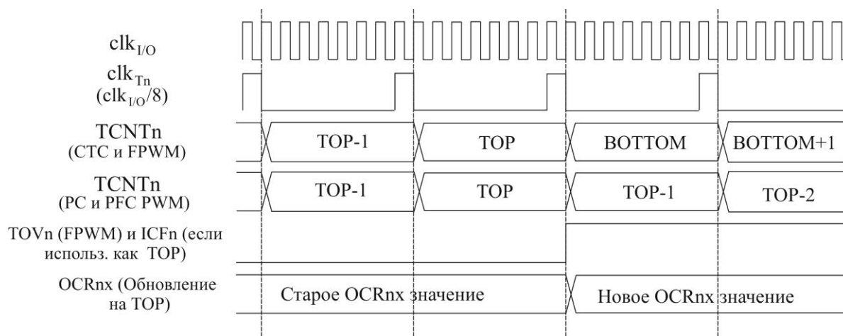
Рисунок 3.50 – Временная диаграмма таймера/счетчика с устройством предварительного деления частоты ( f_{clk\_I/O}/8 )
