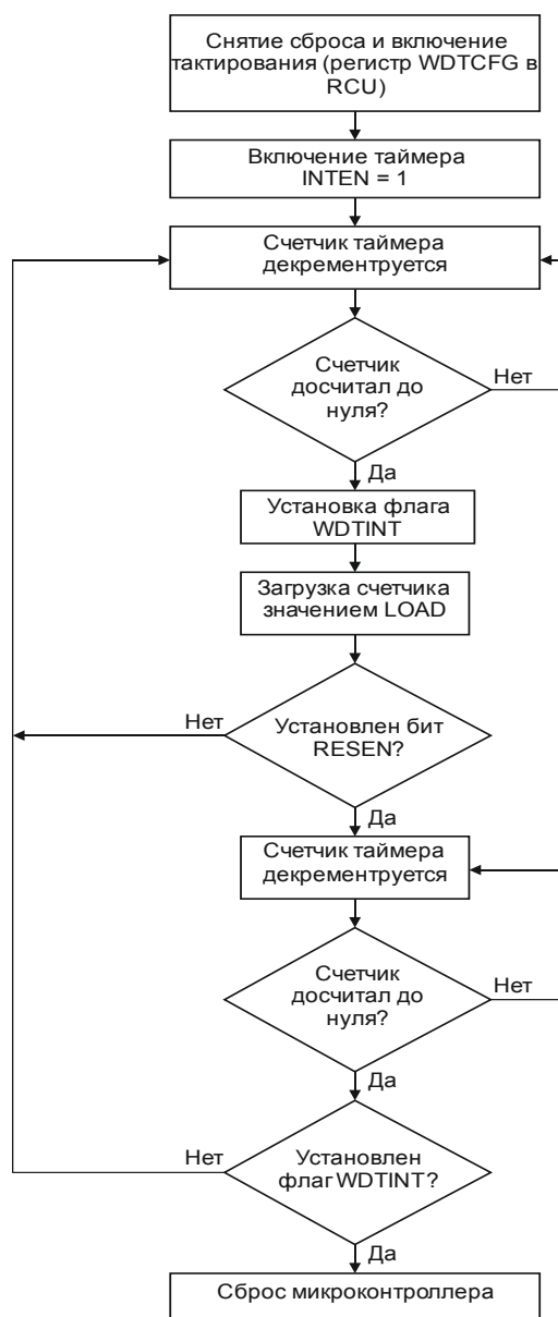
Рисунок 19.1 – Алгоритм работы сторожевого таймера
