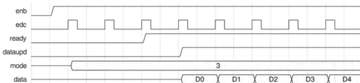
Рисунок 22.4 – Диаграмма переключения внутренних сигналов в режиме 3.
