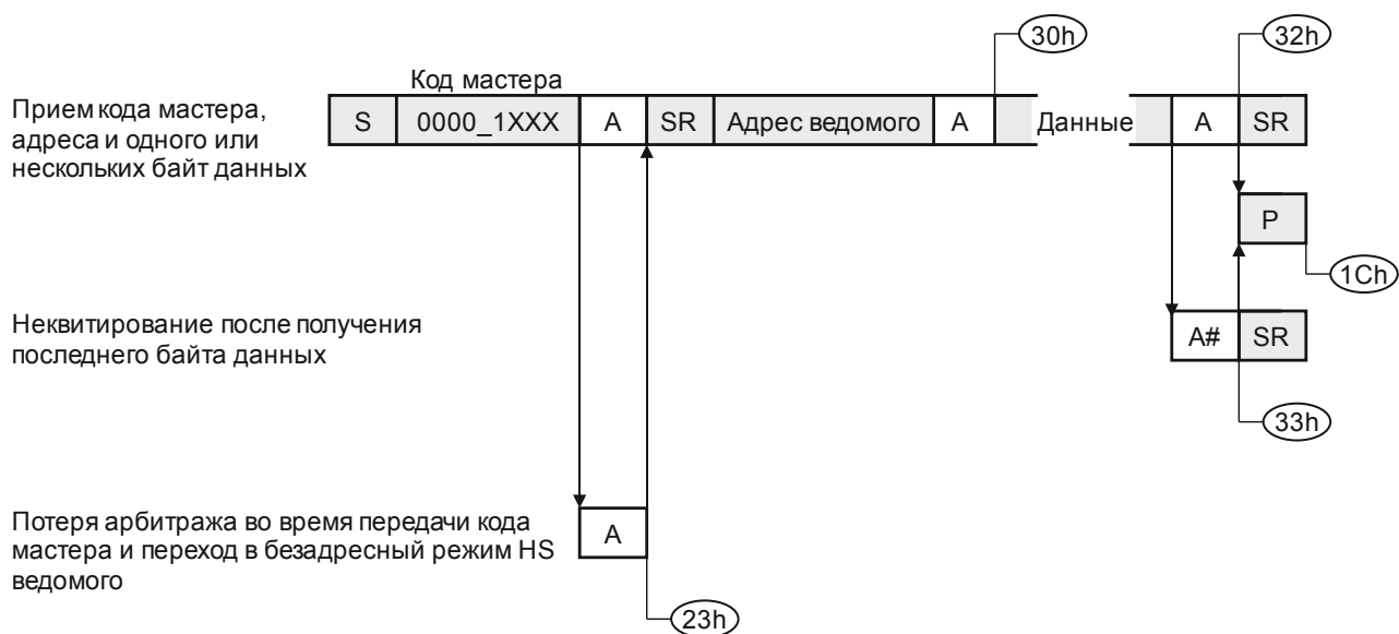
Рисунок 27.21 – Режим HS ведомого приемника
