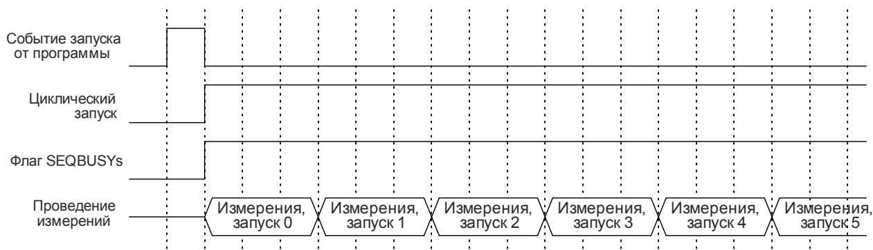
Рисунок 21.7 – Диаграммы работы секвенсора при циклическом запуске
