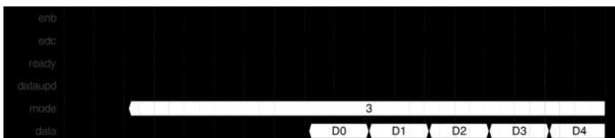
Рисунок 22.4 – Диаграмма переключения внутренних сигналов в режиме 3.
