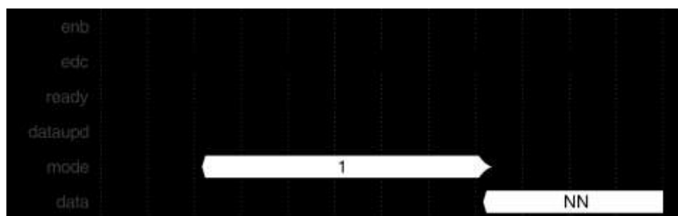
Рисунок 22.2 – Диаграмма переключения внутренних сигналов в режиме 1.
