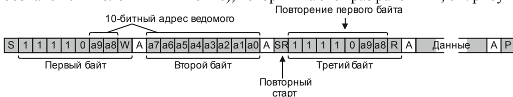
Рисунок 27.11 – Получение данных от ведомого с 10-битным адресом
