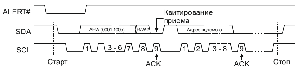
Рисунок 27.9 – Передача адреса отклика на сигнал предупреждения
