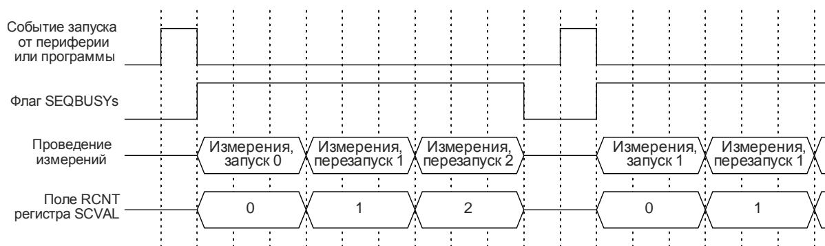
Рисунок 19.4. – Одиночные запуски по событиям с немедленными перезапусками при RCNT = 2 (регистр SCCTL)
