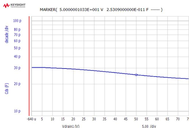
*Зависимость емкости сток-исток от напряжения сток-исток*
