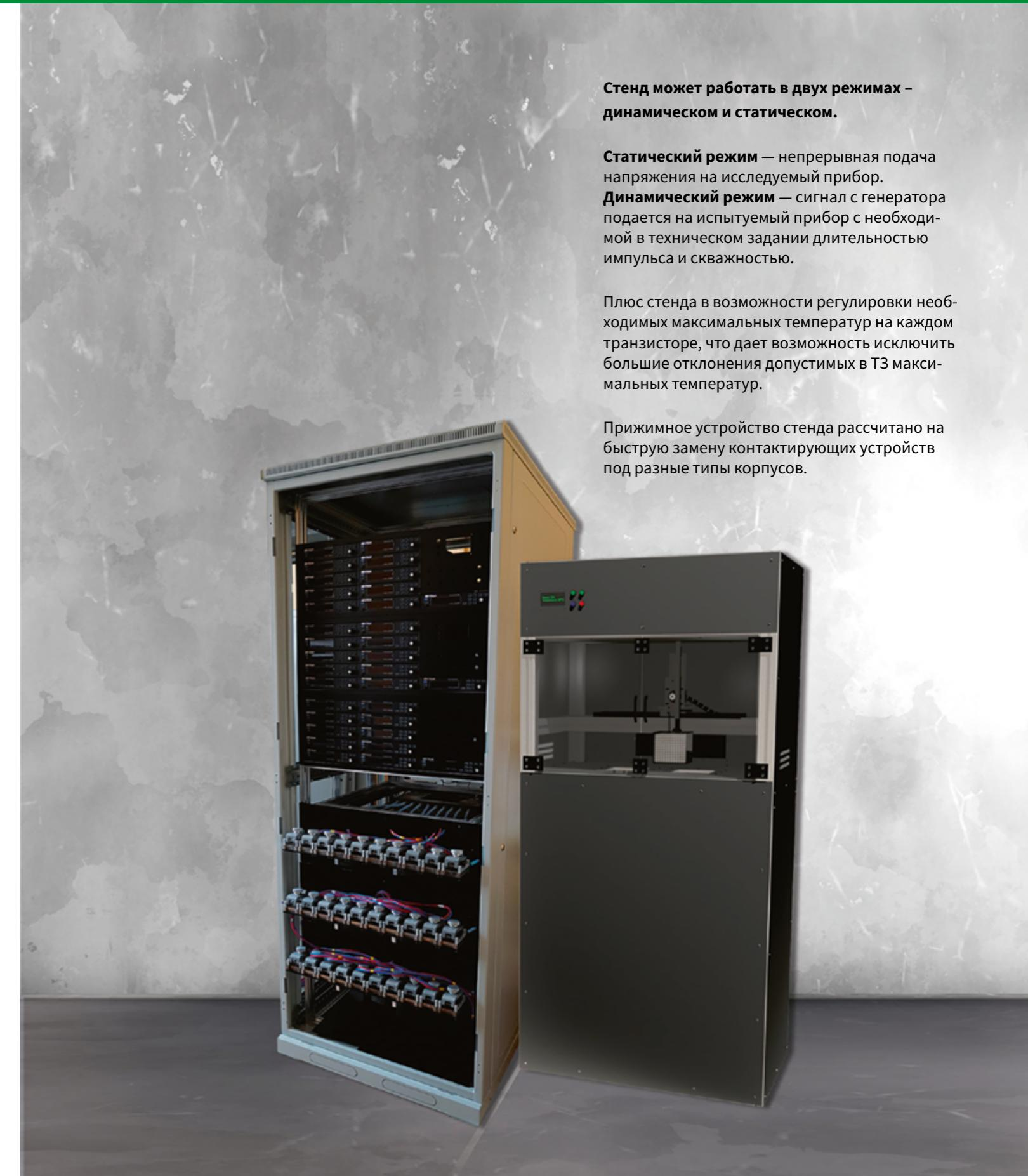
**Стенд может работать в двух режимах – динамическом и статическом.**
