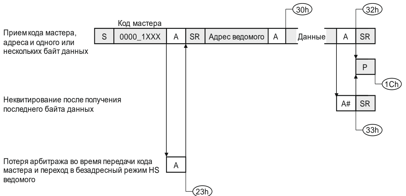
Рисунок 17.21 – Режим HS ведомого приемника
