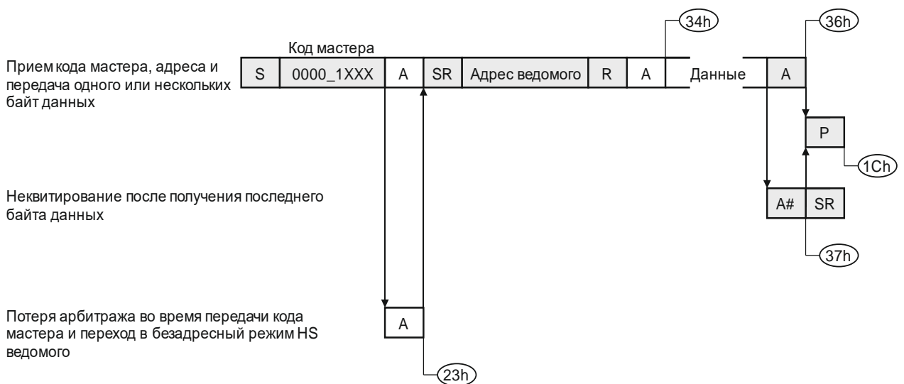
Рисунок 17.23 – Режим HS ведомого передатчика
