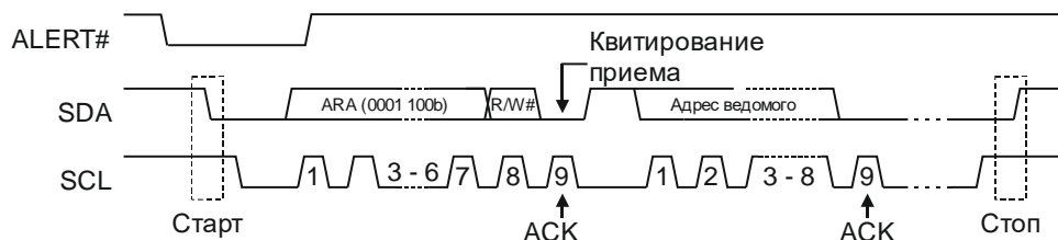
Рисунок 17.9 – Передача адреса отклика на сигнал предупреждения
