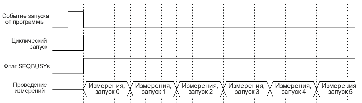
Рисунок 19.7 – Диаграммы работы секвенсора при циклическом запуске
