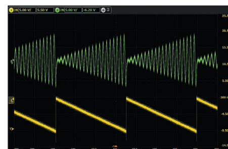
Рис. 7. Осциллограммы сигналов на выходах V_{OUTB1} (вверху) и V_{OUTA} (внизу)
