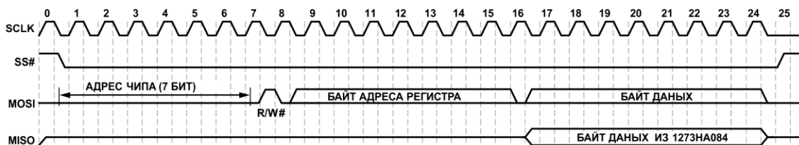
Рисунок 3.10 - Временная диаграмма сигналов при операции чтения по SPI
