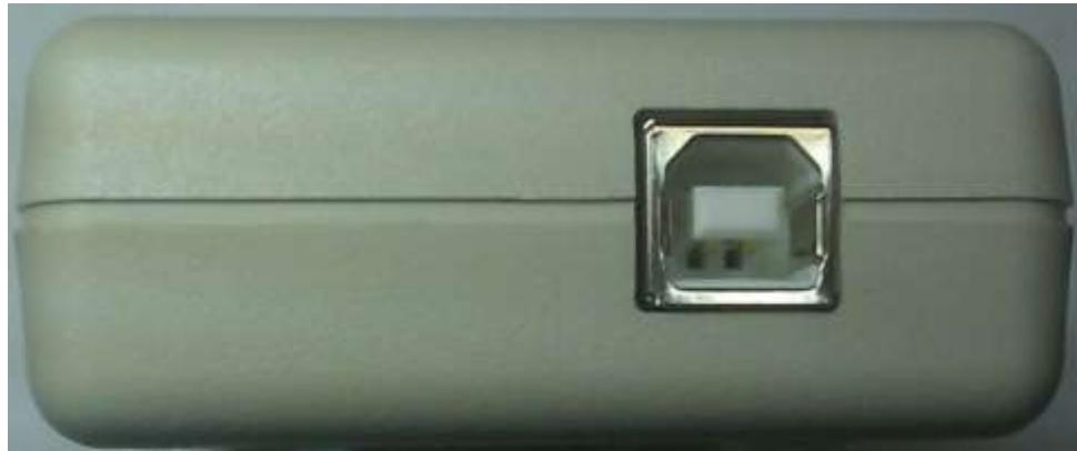
Рисунок 2 – Разъем USB эмулятора JEM-96
