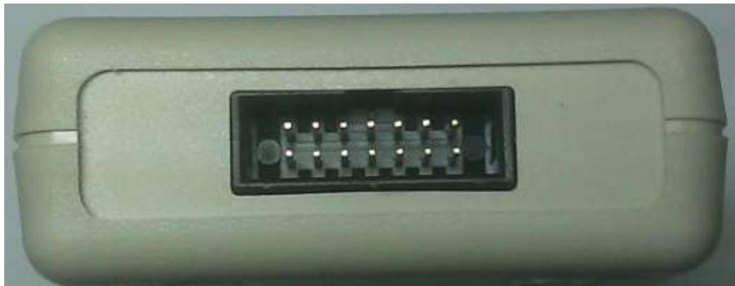
Рисунок 3 – Разъем IDC-14F эмулятора JEM-96
