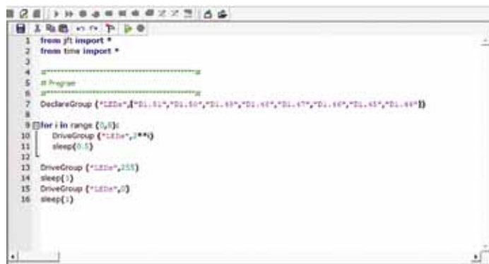
Рис. 6. Программа на Python в JTAG Live Script для тестирования светодиодов отладочной платы
