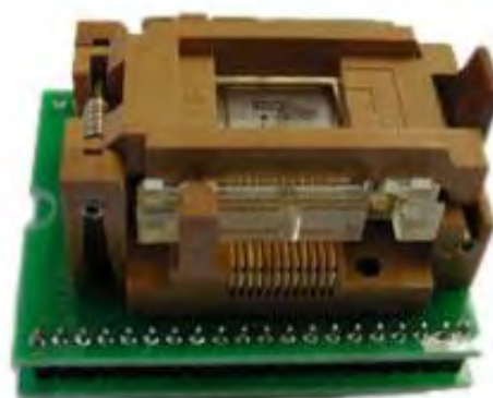
Рисунок 25 – Переходник Н16.48-2В с 48-выводного корпуса на колодку DIP-40
