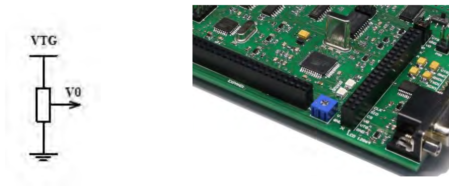
Рисунок 19 – Переменный резистор управления контрастностью
