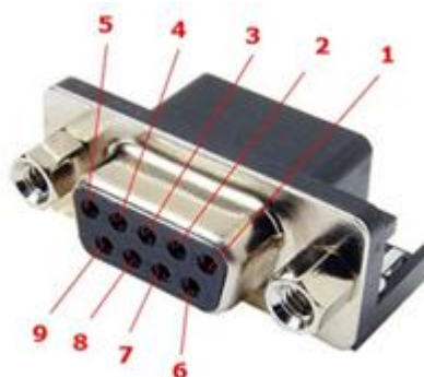
Рисунок 9 – Распиновка интерфейса UART
