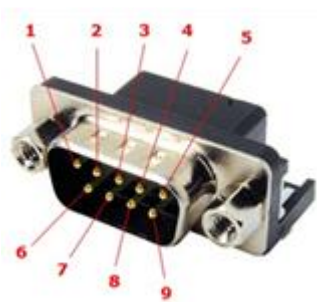
Рисунок 15 – Распиновка разъемов MIL-STD-1553B
